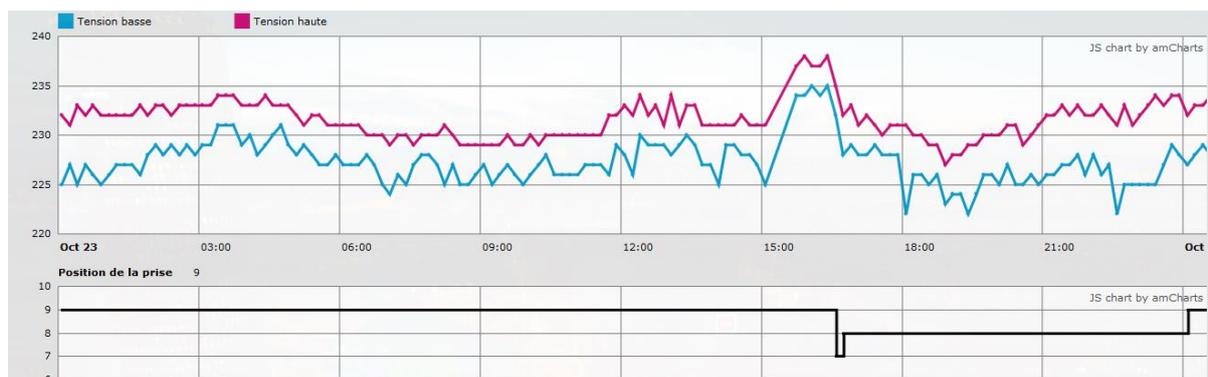
Figure 29 : Exemple d'un changement de prise réussi
