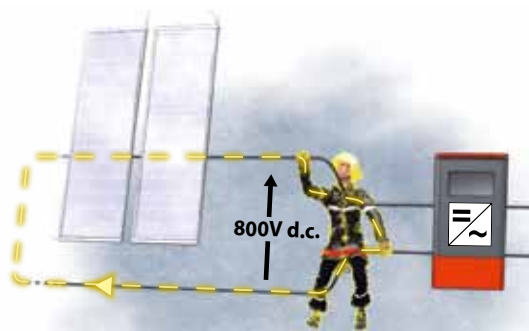
Fig. 18 : Contact direct avec deux conducteurs actifs
