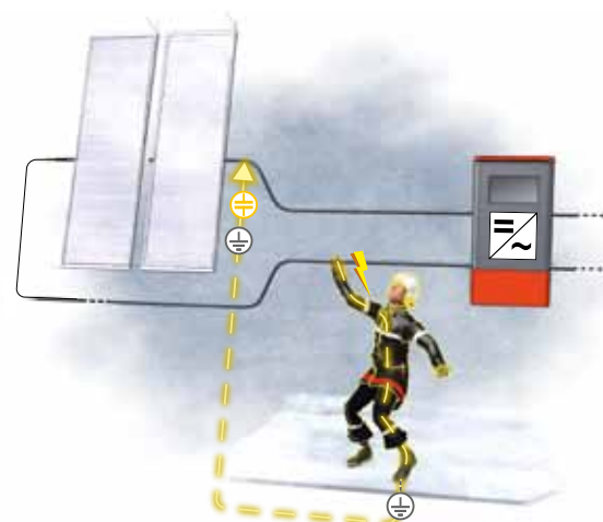
Fig. 20 : Contact direct et décharge capacitive
