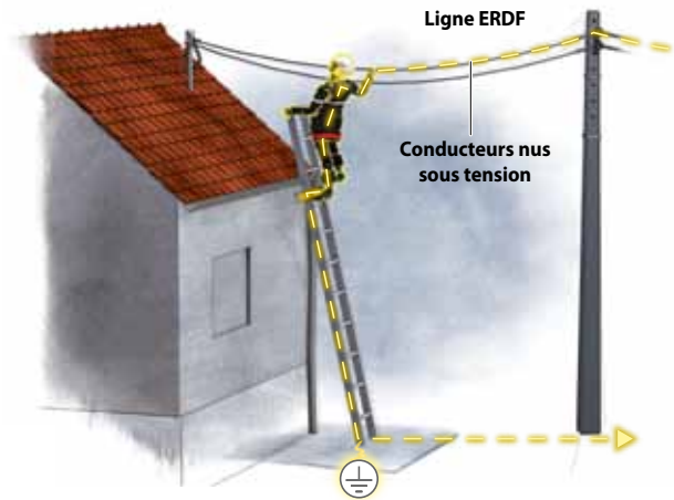
Fig. 12 : Illustration d'un contact direct, d'une part avec un conducteur actif, d'autre part avec la terre au travers de l'échelle « touchant la terre ».
