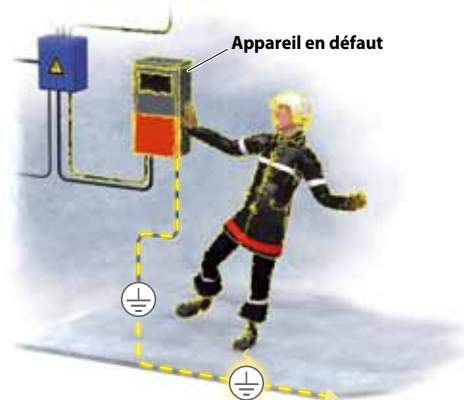
Fig. 13 : Choc électrique par contact indirect
