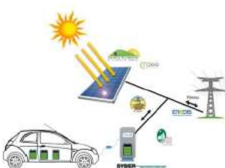
Figure 26 : Lien entre la borne de recharge, la production photovoltaïque et le réseau électrique - Source SYDER
